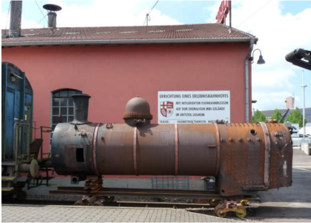
◀ La chaudière d'une locomotive en attente de remise en état
